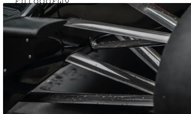
Σύστημα ανάρτησης αγωνιστικού μονοθεσίου F1
