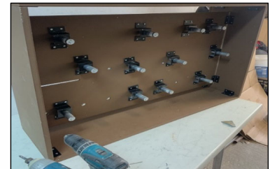
Τοποθέτηση κινητήρων συνεχούς ρεύματος (DC)
